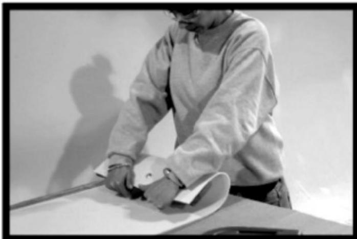
**UTILISEZ LE RENFORT DE GLISSIÈRE 'M77' COMME GABARIT POUR PERCER LE MODÈLE DE TROU INFÉRIEUR DANS LE LIT DE GLISSIÈRE. ASSUREZ-VOUS DE PLACER LE RENFORT DE LA GLISSIÈRE À 1/4" DU BORD INFÉRIEUR DU LIT DE LA GLISSIÈRE AVANT DE MARQUER LE MOTIF DES TROUS.**
